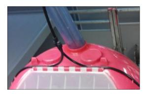
В крышке имеется 3 отверстия для подачи корма, что позволяет правильно регулировать заполнение – в том числе с несколькими кормолиниями. Куполообразный дизайн не позволяет скапливаться пыли и обеспечивает максимальное заполнение воронки.
