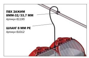
Для подачи воды предусмотрены гибкие шланги, которые закрепляются на крышке бункера. Шланги можно пропустить вдоль вертикальных кормовых труб, чтобы внутри станка было как можно меньше частей. Таким образом упрощается и ускоряется монтаж кормовых автоматов.
