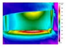
**38,5 °C** Под под Master Heater, в середине **35,2 °C** Пол под Master Heater, справа **33,0 °C** Пол под Master Heater, слева
