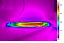
**58,5 °C** Над нагревающим элементом **46,2 °C** Слева над Master Heater **26,0 °C** Рядом с Master Heater, впереди
