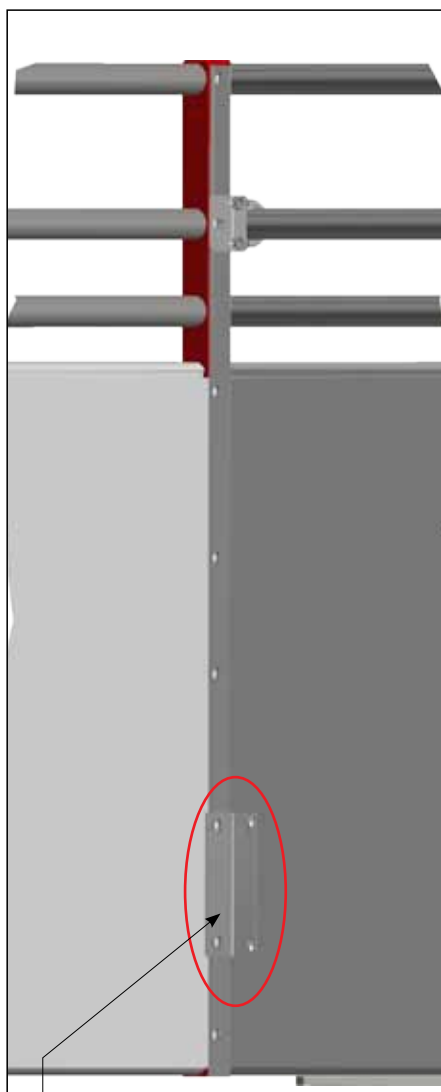
Монтаж с существующими шурупами на перегородке.
