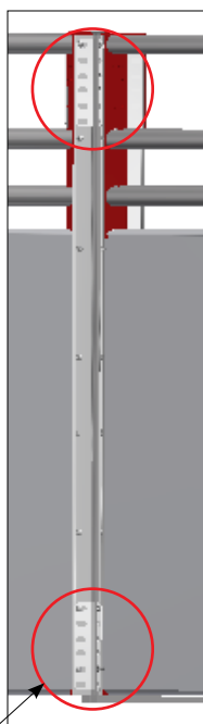
Монтаж с существующими шурупами на перегородке.
